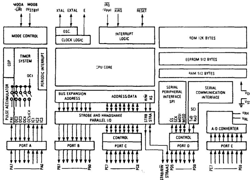
Figure 4 MOTOROLA MC68HC11E9 MICROCOMPUTER
